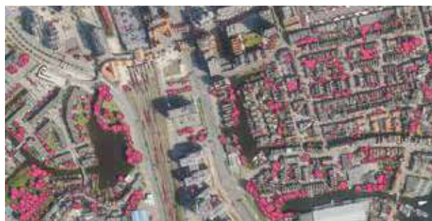
Figuur 8. Gemodelleerde bomen in combinatie met een true orthomosaic.
